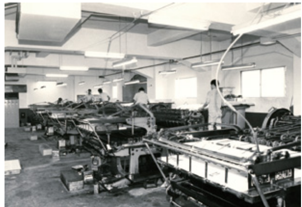
市ヶ谷工場新社屋 1 階に並列設置された 5 台の 2 回転活版印刷機
